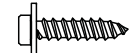
Self-Tapping Washer-Head Screw Schraube mit Unterlegscheibenkopf Vis auto-taraudeuse épaulée Vite autofilettante flangiata
